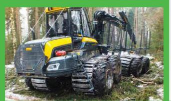
Le **système B.S.R. Twin Tyre** peut être utilisé sur tous les porteurs, débusqueurs et abatteuses, n'importe si c'est en 4-, 6- ou 8 roues.
